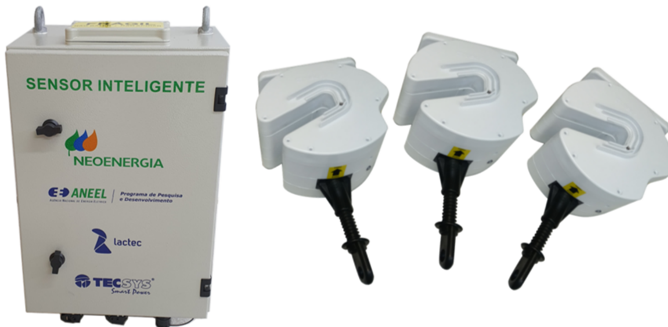
Figura 1 - Conjunto Sensor Inteligente composto pelos Sensores e Unidade Concentradora
