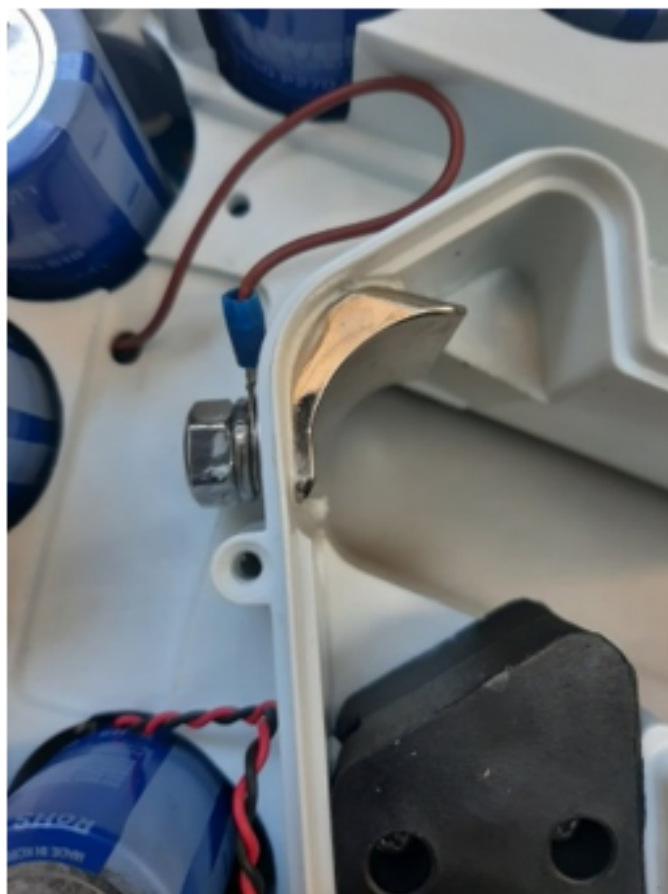
Figura 5 - Detalhe do contato de equipotencialização
